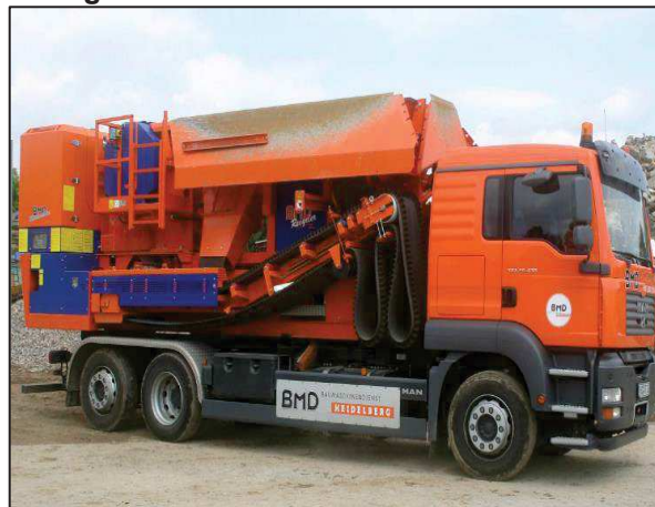
Figura 86 - Usina móvel de RCC.
