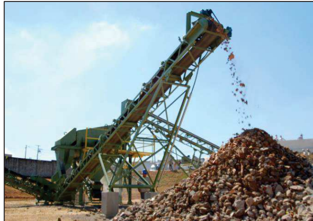
Figura 85 - Usina fixa de RCC.
