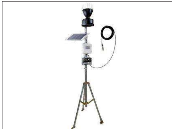
Figura 109 - Estação Fluviométrica Automática.
