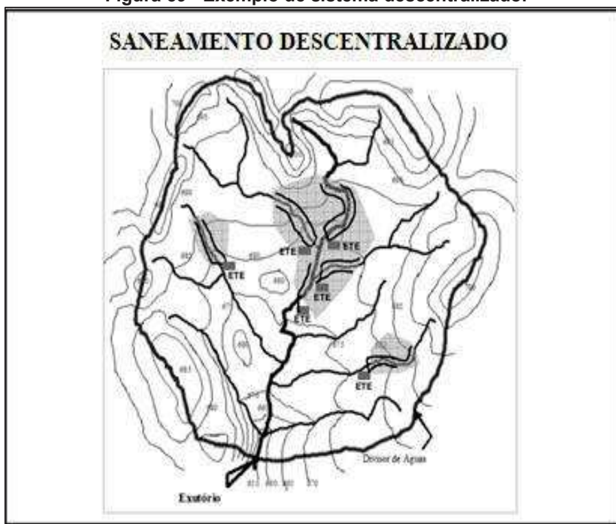
Figura 59 - Exemplo de sistema descentralizado.
